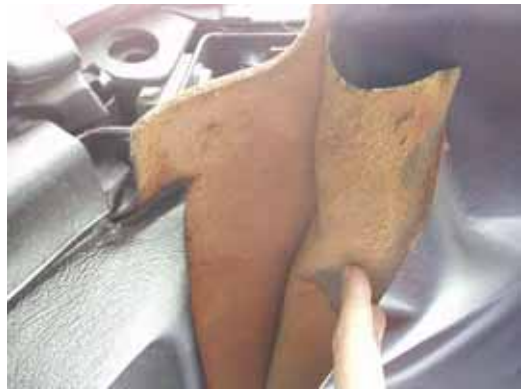
18. 内張を外す途中の様子ですこんな感じでベロベロになっていました。〜^^〜
