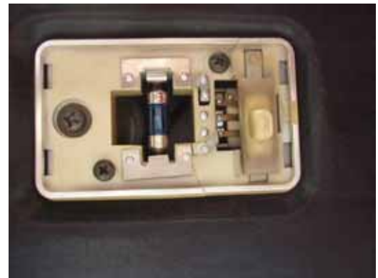
55. 後側室内灯もしっかり取り付きました。劣化によるヒビが入っていたのでアロンαで接着補強しました。
