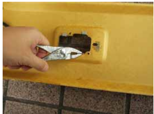
24. こじりあがった金具をペンチでつまんで丁寧に曲げて外していきます。
