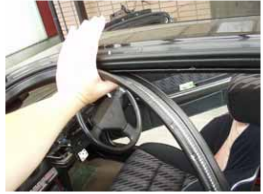
51. シールゴムを丁寧に取付けていきます。分解して分かったことですが、Zのパーツはそれぞれがしっかりしていますね。
