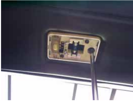
5. 室内灯カバーを外してネジ3個をゆるめて外します。この車も20年になるのでプラスチックはかなりもろくなっているのでヒビがはいています。作業は慎重に・・・。
