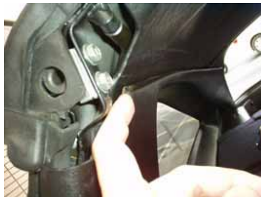
48. 後ろ側ボディ内張を少し指で引っ張りながらルーフ内張をはめ込むと貼った皮が剥がれたり傷ついたりせず滑り込みながらはまります。 この作業は左右両方同時なので二人作業がベストですね。
