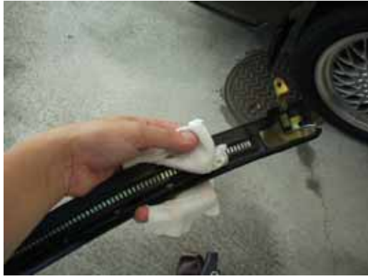
51. Tバールーフのシールゴムは取付け前にぬれたウエスできれいに掃除しておきましょう。
