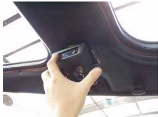
10. 前側室内灯の本体左右をしっかり握り真下に下げて外します。
