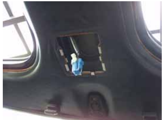
12. 前側室内灯の配線コネクタを外します。
