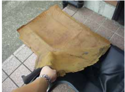
26. 内張のビニールを剥がしていきます。ほとんどペロペロなので簡単に剥がれます。
