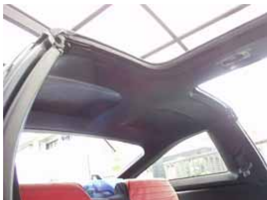
47. さて作業最終日での取付け作業です。 綺麗に仕上げた内張を傷つけないよう最後まであわてず作業しましょう。 まずは後ろからはめ込んでいきます。
