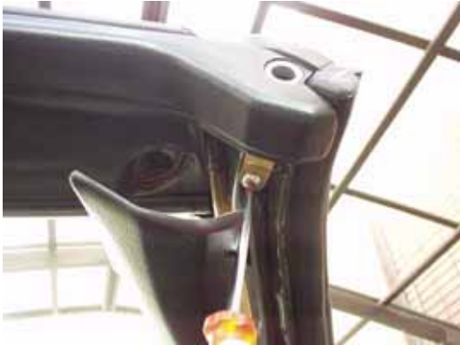
8. Tバールーフのシールゴムを外します。
