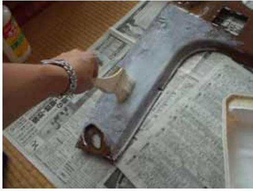
37. さて作業二日目です。今日もがんばりましょう。いよいよ接着作業開始です。接着剤は木工用ボンド(徳用)に水50:50で混ぜたものを使用しました。
