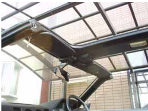
56. バックミラーや各部品を取付けて作業完了です。
