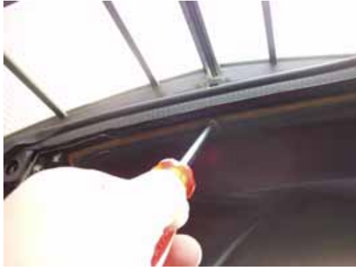
13. 内張の止めネジを外していきます。
